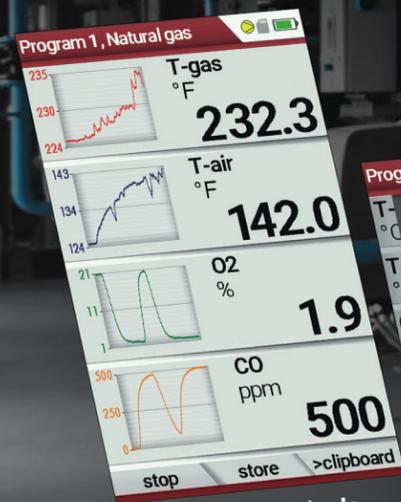
Pantalla de medición de gases de combustión con gráficos
