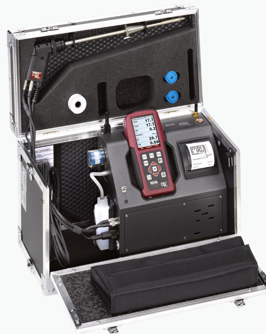
**Unidad de control remoto en edición confort, también utilizable como instrumento de medición independiente, ej.: para impresión, temperatura, detección de fuga y más**
