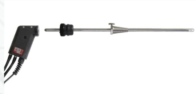
**Sonda de muestreo de gas** para combustiones industriales, sin calefacción, sin filtro para monitoreo de emisiones cortas y completas, incluido NO<sub>2</sub>/SO<sub>2</sub>, mango de sonda para tubos intercambiables, con línea de muestreo de gas de 9 pies (tipo VITÓN)
