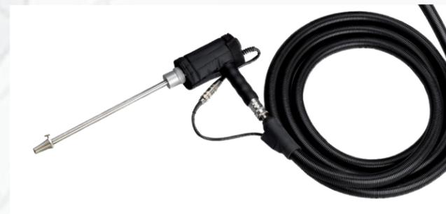
**Sonda de muestreo de gases** para combustiones industriales, con mango de sonda calentado y filtro de lana de vidrio de cuarzo, fácilmente reemplazable para tubos intercambiables
