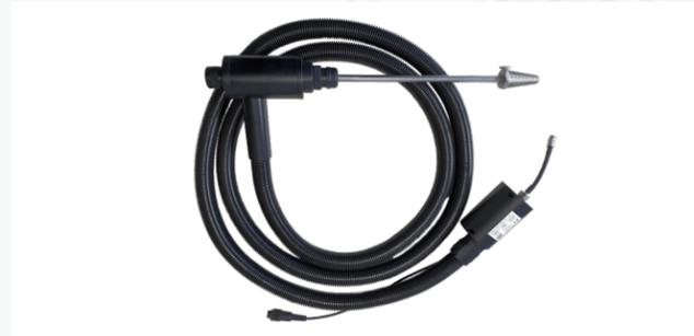
**Sonda de muestreo de gas calentado** con línea de muestreo, longitud de 9 pies, temperatura regulada de 266°F (130°C), medición de la temperatura del gas usando un termopar tipo K. Con filtro de lana de cuarzo reemplazable fácilmente
