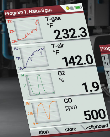
Pantalla de medición de gases de combustión con gráficos
