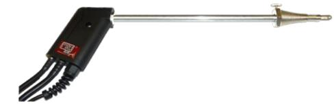
Sonda estándar de inserción de 250mm y 1.5m de línea de muestreo con separador de condensados y termopar tipo K (1200° max.)
