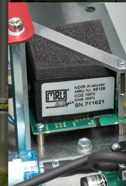
Banco NDIR para análisis de CH 4 /CO 2 , para biogás y mediciones de gas de vertedero
