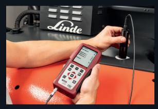
El número de hollín de Bosch se determina con el Densitómetro, que es conectado a la unidad de control remoto del NOVA plus.
